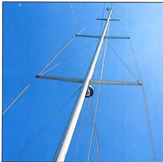
Per armare Uldb 65 è stato scelto un piano in testa d'albero con boma piuttosto importante e superfici non molto allungate per contenere l'altezza del centro velico. La superficie è ben gestibile anche con un equipaggio non numeroso.
