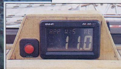
un ripetitore della centralina elettronica con il portastrumenti in teak.
