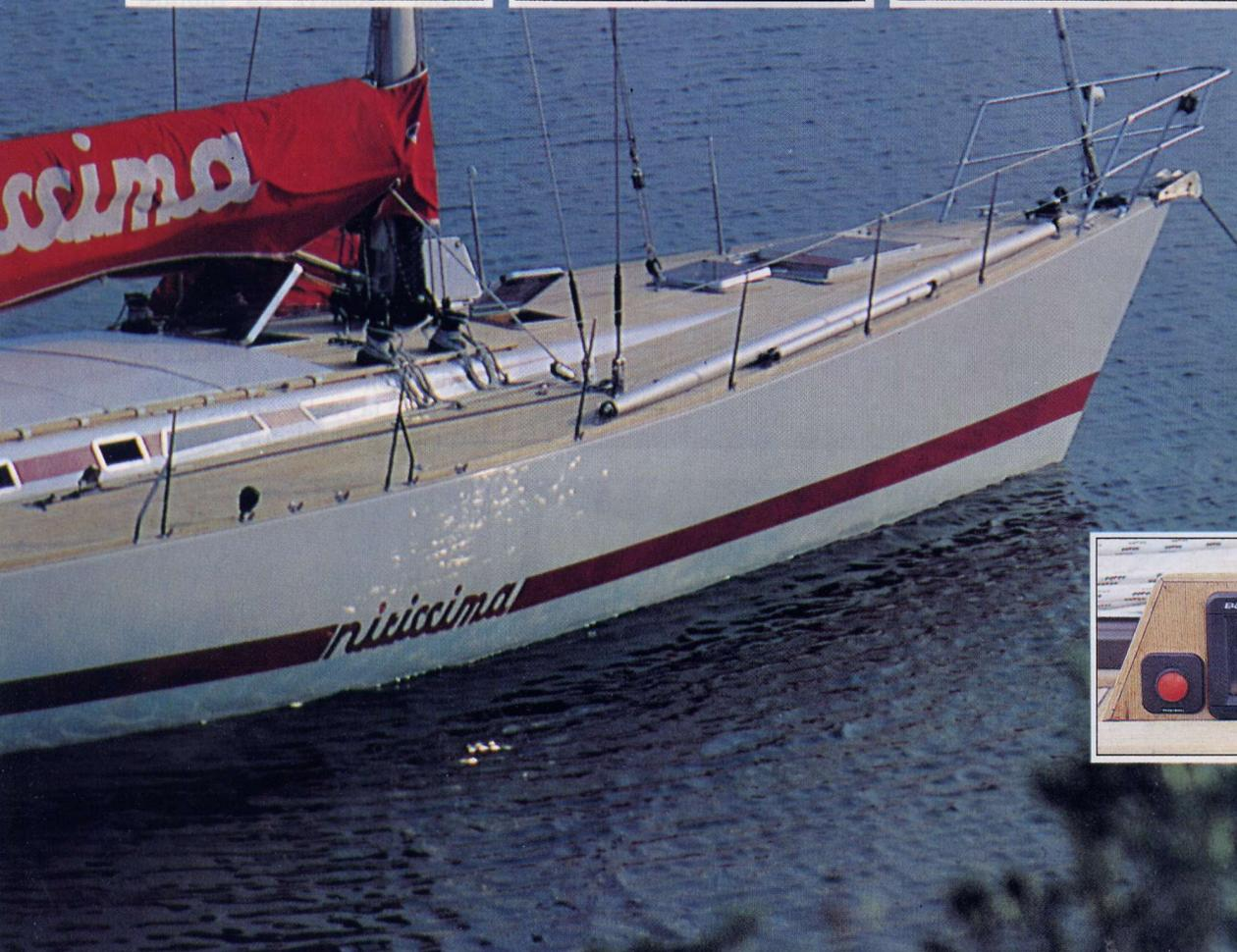
In alto da sinistra la rotaia per la scotta della randa, sulla tuga appena davanti alla discesa sottocoperta, rinvia ad un winch in pozzetto; una delle maniche a vento protette che dà aria agli interni; il musone di prua con il verricello per l'ancora e, chiuso, il gavone per le cime di ormeggio. In questa piccola foto
